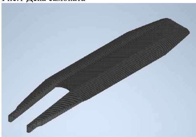
Рис.2 Дека самоката Габариты: В x Ш x Д=52,2x147,4x619 мм
